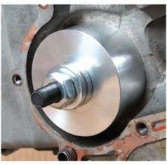
3. Insérer la première rondelle sur la vis, puis appliquer de la graisse épaisse...
