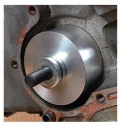
2. Mettre en place l'arrache roulement sur le carter.
