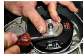
**DESSERRE LE BLOC PISTON ET SERVEZ VOUS EN COMME PIGE EN TOURNANT LE VILEBREQUIN POUR TROUVER LE POINT MORT HAUT. AU POINT MORT HAUT FAIT COÏNCIDER LES REPERES ROUGE DU STATOR ET DU ROTOR ET SERRER LE ROTOR AVEC LA RONDELLE ET L'ECROU D'ORIGINE.**
