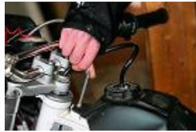
**APRES AVOIR RETIRE LES FLANS DEPOSER LA VIS DE FIXATION SUPERIEUR DU RESERVOIR A L'AIDE**
