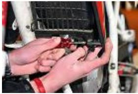
**RETIRER LES VIS DE FIXATION INFERIEURES DES FLANS DROIT ET GAUCHE AUTOUR DU**
