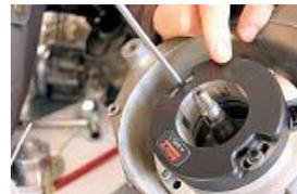
**RECUPERER LE PASSE FIL DU STATOR D'ORIGINE ET LE POSITIONNER DANS BON SENS SUR LA GAINE DU STATOR PREMIUM. PRESENTER LE STATOR PREMIUM SUR LA PLATINE EN PASSANT LA GAINE PAR LE TROU DU CARTER ET LE SERRE AVEC LES 2 VIS 5 X 30 MM FOURNIE.**
