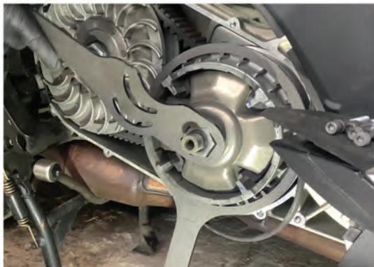
Pour le remontage, serrer l'écrou à un couple de 100 Nm.
