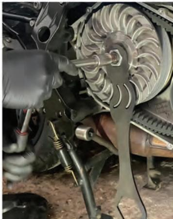
Pour le remontage, serrer l'écrou à un couple de 100 Nm.
