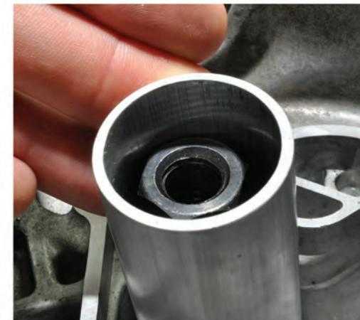
5. Insérer la vis d'extraction avec l'écrou, la rondelle, le roulement à aiguilles (avec une peu de graisse épaisse) et la rondelle.
