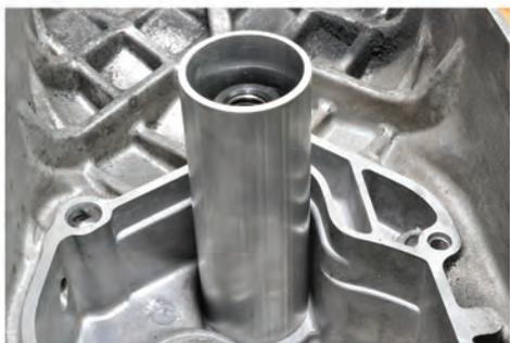
4. Avant de visser la vis d'extraction, il est nécessaire de bloquer l'extracteur en rotation en poussant le tube contre celui-ci.
